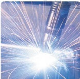
Das Schutzgas-MAG/MIG Schweißen wird in nahezu allen Bereichen der Metallverarbeitung angewendet. Der Anwendungsbereich reicht vom Schweißen dünner Bleche im Karosseriebau bis zum Fügen dickwandiger Bauteile im Stahlbau. Verarbeitbare Werkstoffe sind alle Stahlsorten, aber auch Aluminium. Durch die hohe Abschmelzleistung ist es wirtschaftlicher als das Elektro-Lichtbogenhandschweißen, jedoch nur bedingt für den Einsatz bei Montagen verwendbar.
