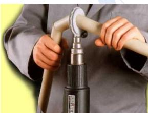
Das Kunststoffschweißen wird hauptsächlich für die Anfertigung von Kunststoffrohrleitungen aber auch im konstruktiven Apparatebau für die Verbindung von Form- und Flacherzeugnissen diverser Kunststoffarten mittels unterschiedlicher Schweißtechniken eingesetzt
