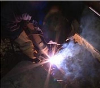
Das Elektro-Lichtbogenhandschweißen findet seinen Einsatz hauptsächlich beim Verbinden von Blechen und Rohren aller Stahltypen, aber auch Gußeisen. Es können Blech- bzw. Rohrwanddicken ab 2 mm in allen Positionen verschweißt werden. Das Verfahren wird vor allem auf Baustellen eingesetzt.
