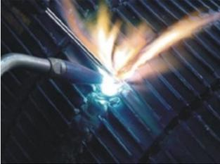
Das Gasschweißen wird hauptsächlich zum Verbinden von Rohren aus unlegierten und niedrig legierten Stählen in allen Positionen eingesetzt. Der wirtschaftliche Einsatz dieses Schweißverfahrens ist üblicherweise durch Wanddicken bis 4 mm begrenzt. Es eignet sich vor allem für den Einsatz auf Baustellen.
